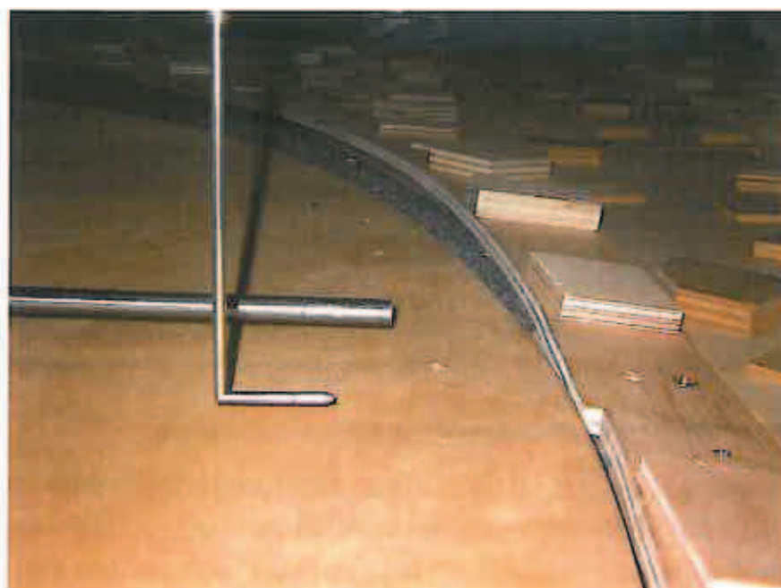
Figure 3 : anémomètre à fil chaud et tube de Pitot utilisés pour la mesure de la turbulence du vent à échelle réduite en soufflerie.
