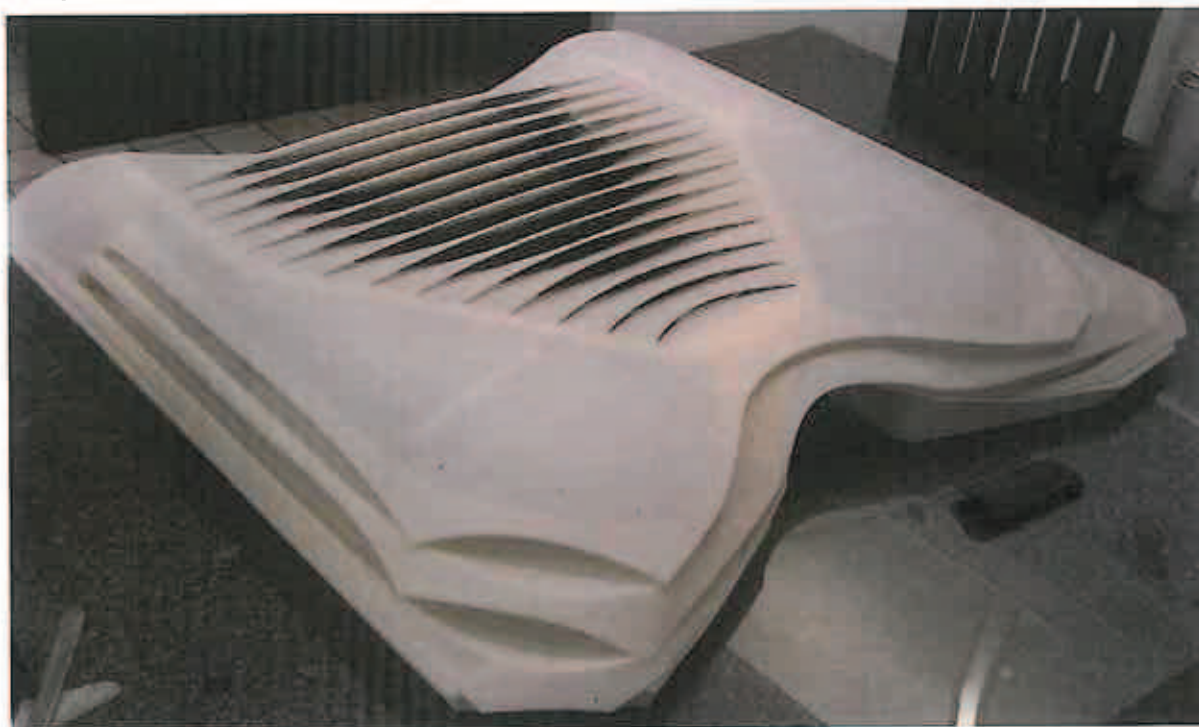
Figure 8 : Modèle du bâtiment obtenu par frittage de poudre
