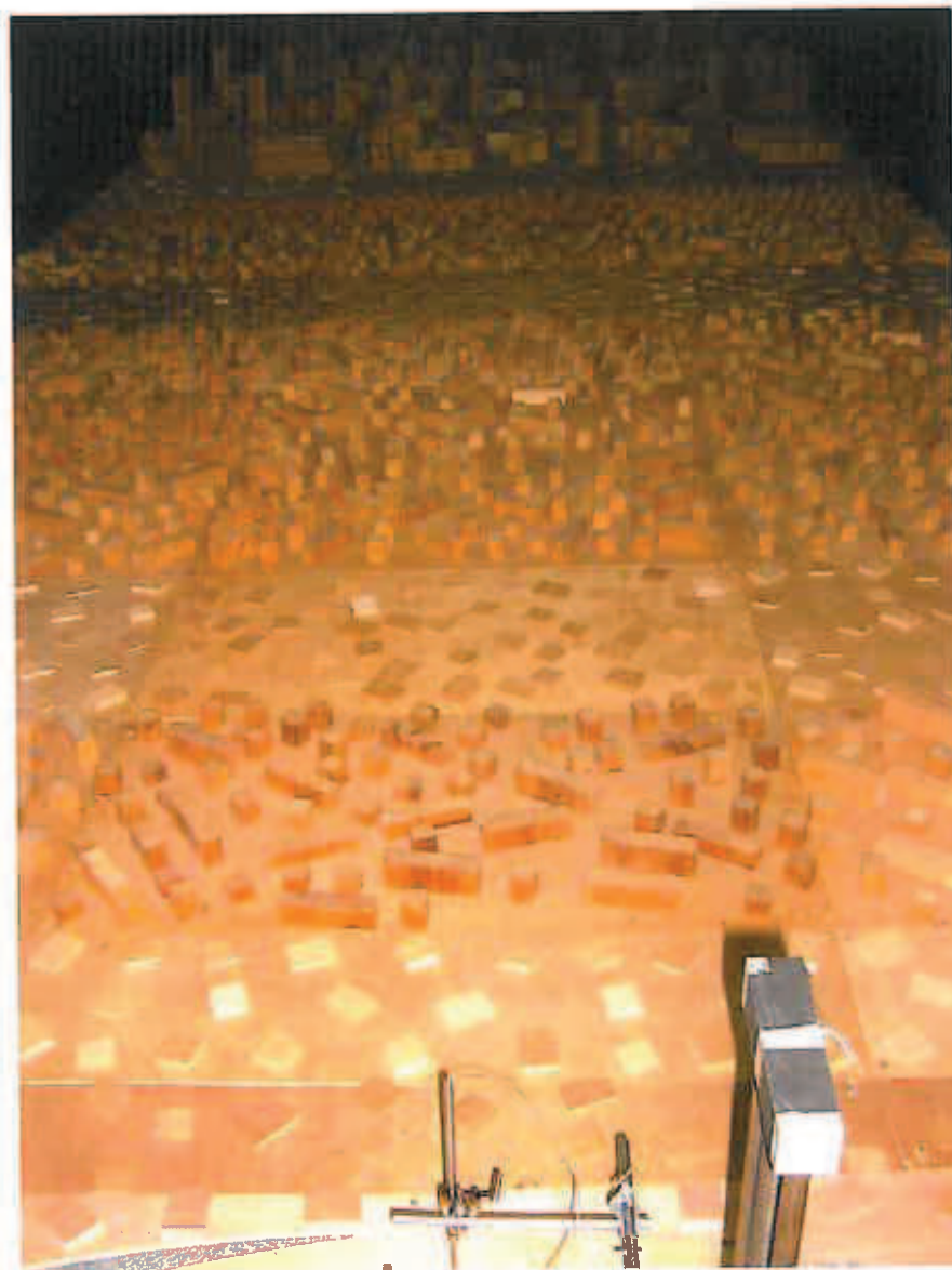
Figure 2 : simulation en soufflerie de la couche limite terrestre à l'aide de rugosités calibrées placées en amont de la zone de mesure.
